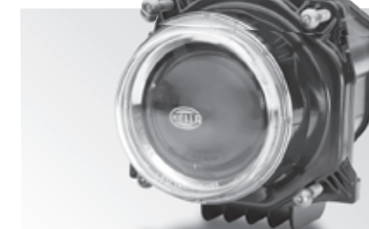
Freie Auswahl: Solche Module mit Prüfzeichen gibt es für Halogen-, Xenon- und LED-Lichtquellen
